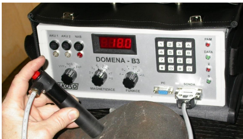
Obr. 5 – Doména B3 – součástí přístroje je válcová sonda s Hallovým snímačem v ose plochého čela, který detekuje zbytkový magnetismus M
