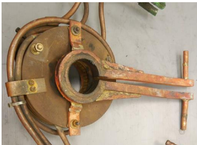
Obr. 3 – Induktor pro kalení vačkových hřídele Tedom
